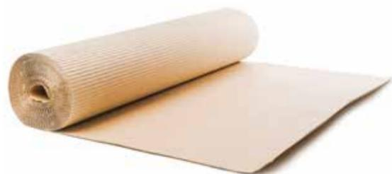
Épaisseur 2,5 mm, carton ondulé robuste à imprégnation à effet de régulation de l'humidité. Comme les stries sont entièrement pleines, elles gardent leur forme même sous pression, et gardent ainsi leur fonction même en cas de charge de poids importante sur le sol. Fabriqué à 100 % en papier recyclé. **Utilisation:**
